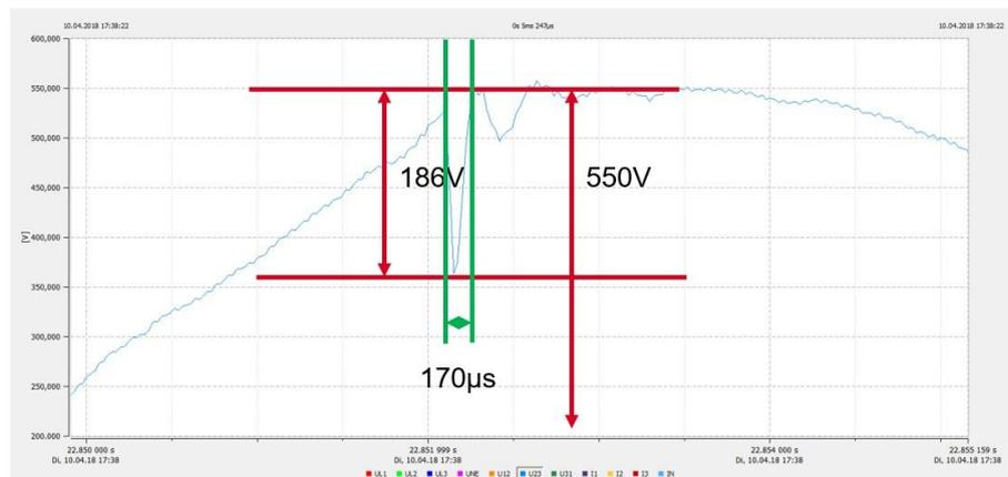
图 70：缺口计算示例，其中缺口深度和换相面积为 OK。这些缺口可接受。
