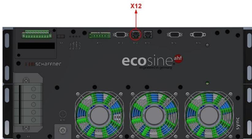
图 42 ecosine active sync 模块上端子 X12 的位置
