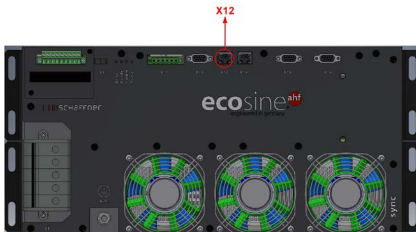
Figura 42 Ubicación del terminal en el módulo ecosine active sync
