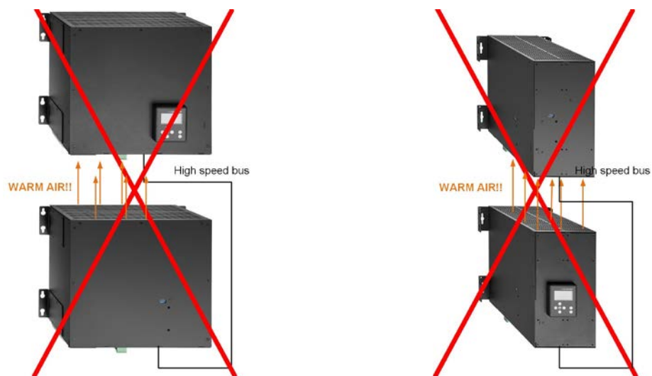
Figura 11 Montajes erróneos del DPP
