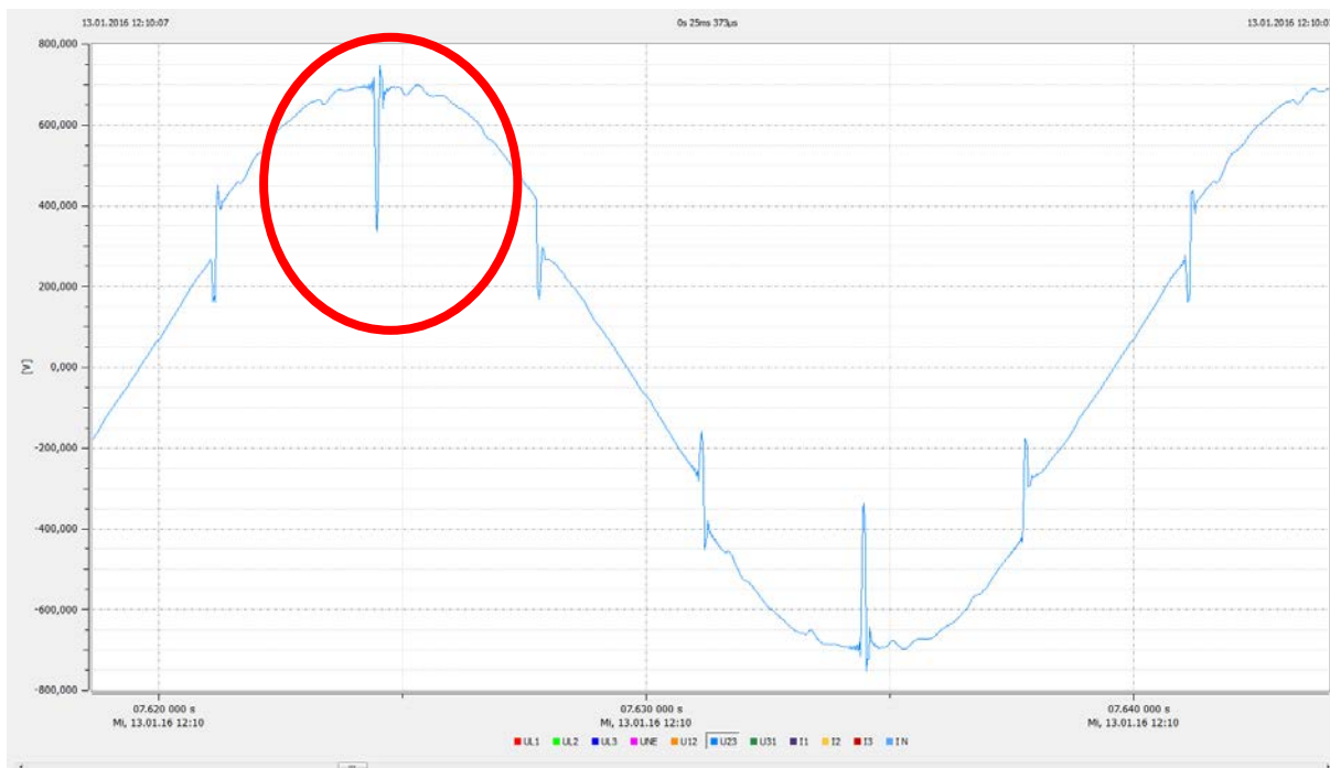
Figura 67 Ejemplo 2, tensión fase a fase U23 con un muestreo > 10kHz
