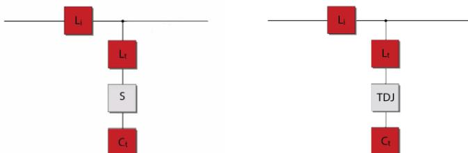
图 2 FN3471, FN3473, FN3481 和 FN3483 的滤波器配置
