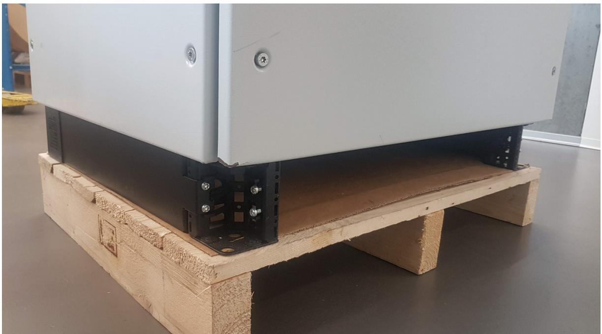
图 8 机柜背面的开口。基座应保持打开，以便电缆进入和冷却。
