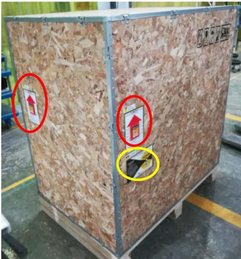
图 22 TiltWatches 和 ShockWatch 的位置
