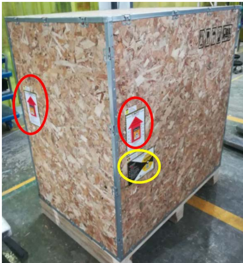
Abbildung 22 Platzierung der TiltWatch- und ShockWatch-Indikatoren
